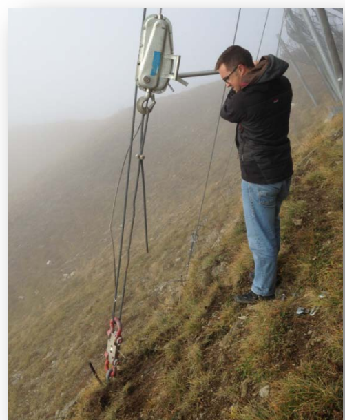
Montaje del Sensor de carga de 10 Toneladas
